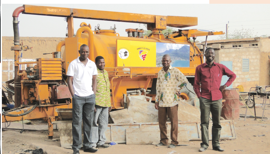
Hydrocureuse (avec citerne à eau et pompe haute pression) financée par Annecy-le-Vieux.
